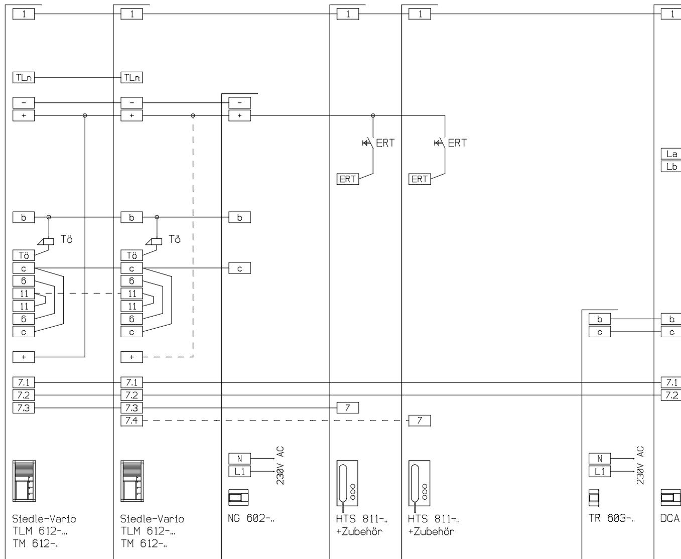
Die max. Reichweite zwischen TR 603-0 und dem DCA 612-0 darf max. 20m sein, bei 0,8mm. Zuleitung muß vom TR 603-0 direkt zum DCA 612-0 erfolgen. Bei Verwendung der Ein- und Ausgänge des DCA sind entsprechende Adern vorzusehen.
